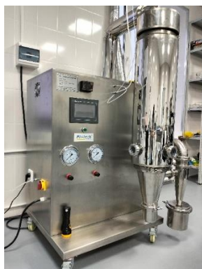
Рис. 4. Распылительная сушилка Spray Dryer YC-018 (фото авторов)
